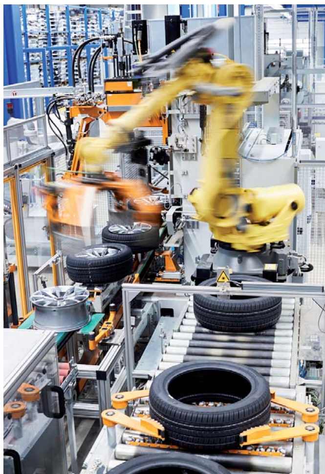
Automatisierte Herstellung von Radsätzen: Industrie 4.0 made in Emden. Fotos: DirksGroup/Stefan Bergmann
